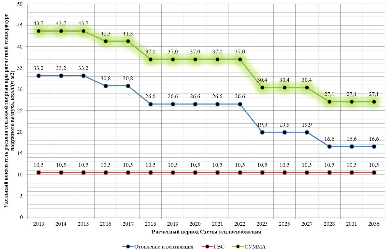
Рисунок 1.3 - Изменение нормируемого удельного расхода тепловой энергии на отопление, вентиляцию и ГВС на примере жилого 12-этажного многоквартирного дома
