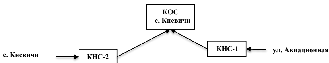
Рисунок 3.22 - Принципиальная схема распределения потоков канализационных стоков в Технологической зоне №4
