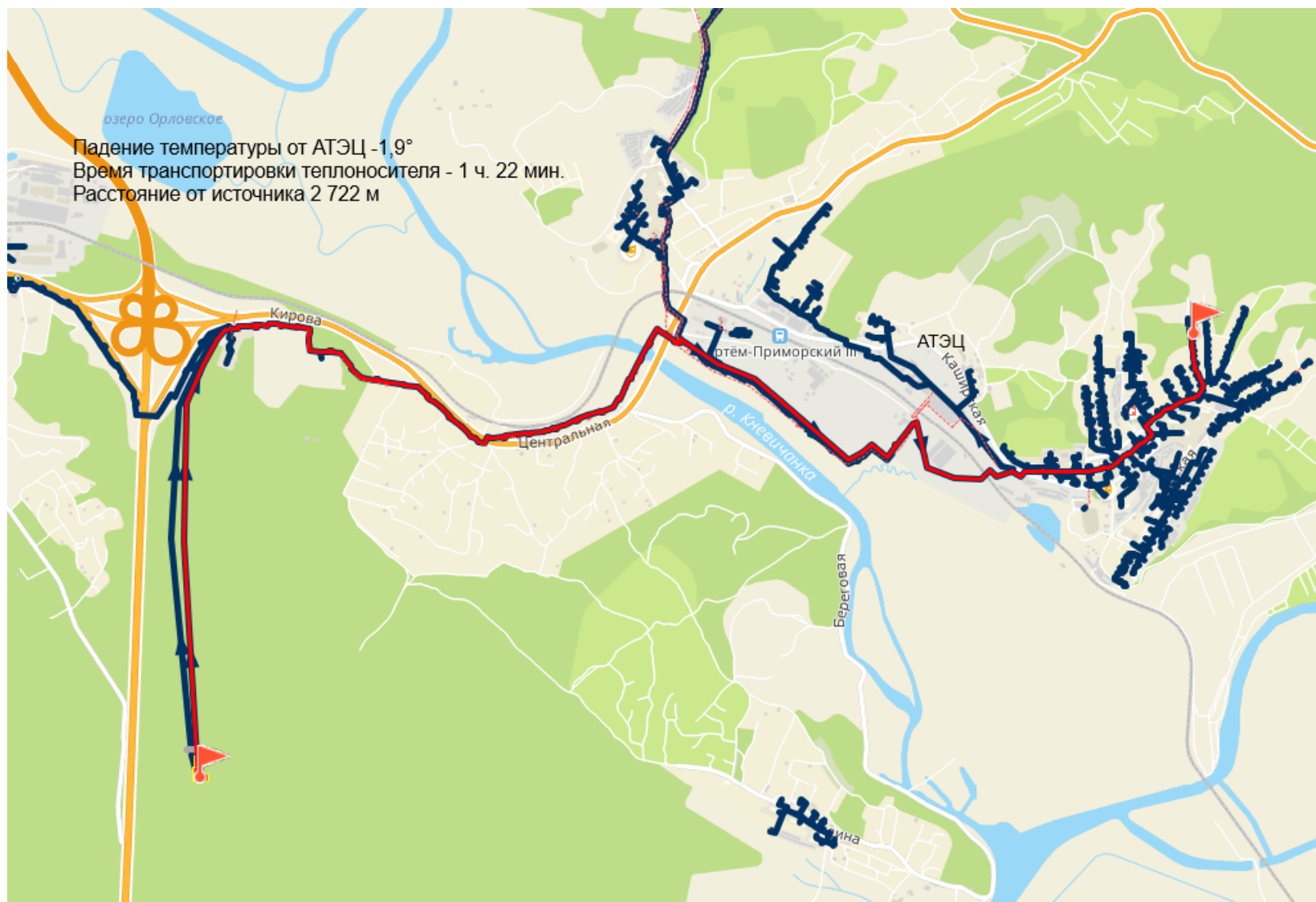
Рисунок 6.6 – Путь для построения пьезометрического графика участка от новой АТЭЦ-2 в направлении п. Артемовский
