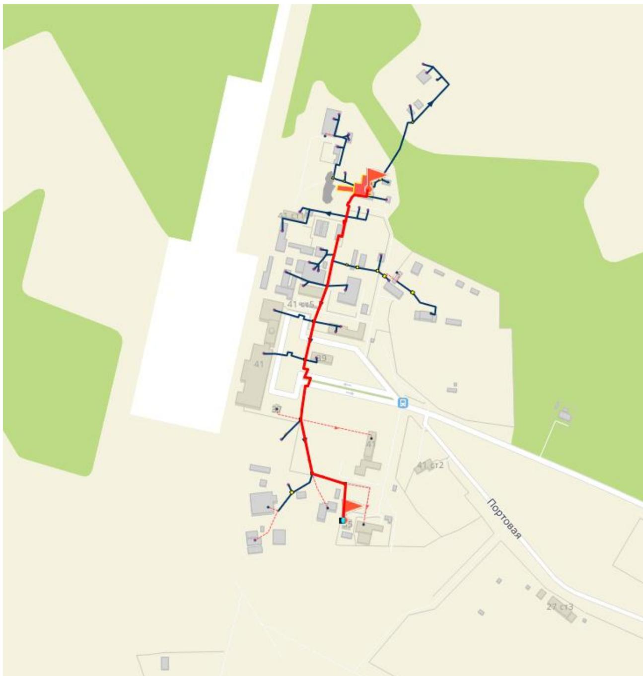
Рисунок 6.27 – Трасса от котельной «Аэропорт» до ул. Портовая, 41
