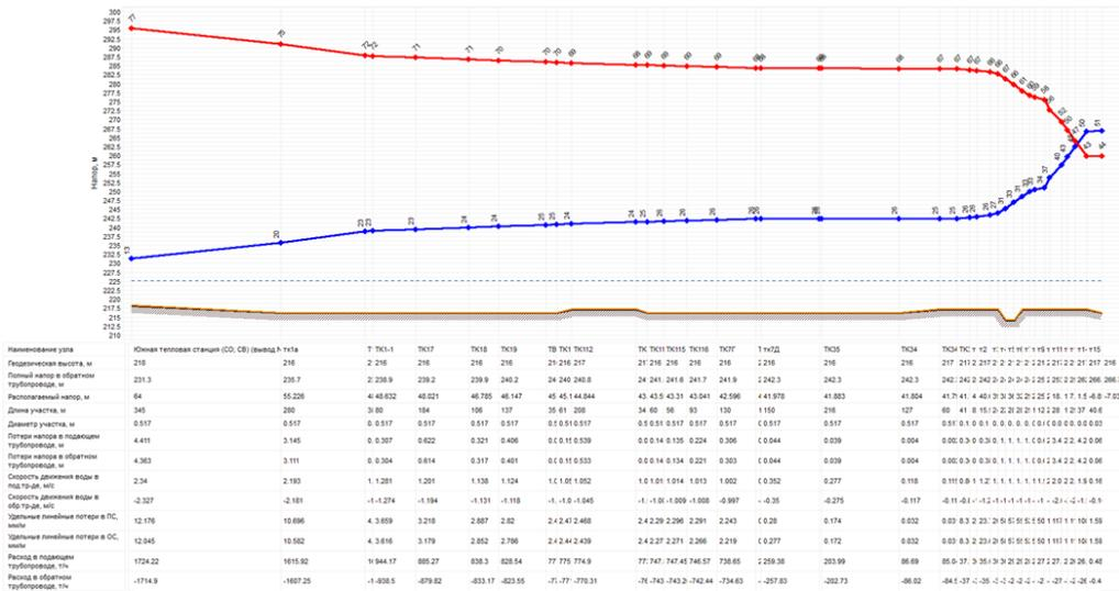
**Рисунок 2.3 – Пьезометрический график пути движения теплоносителя**
