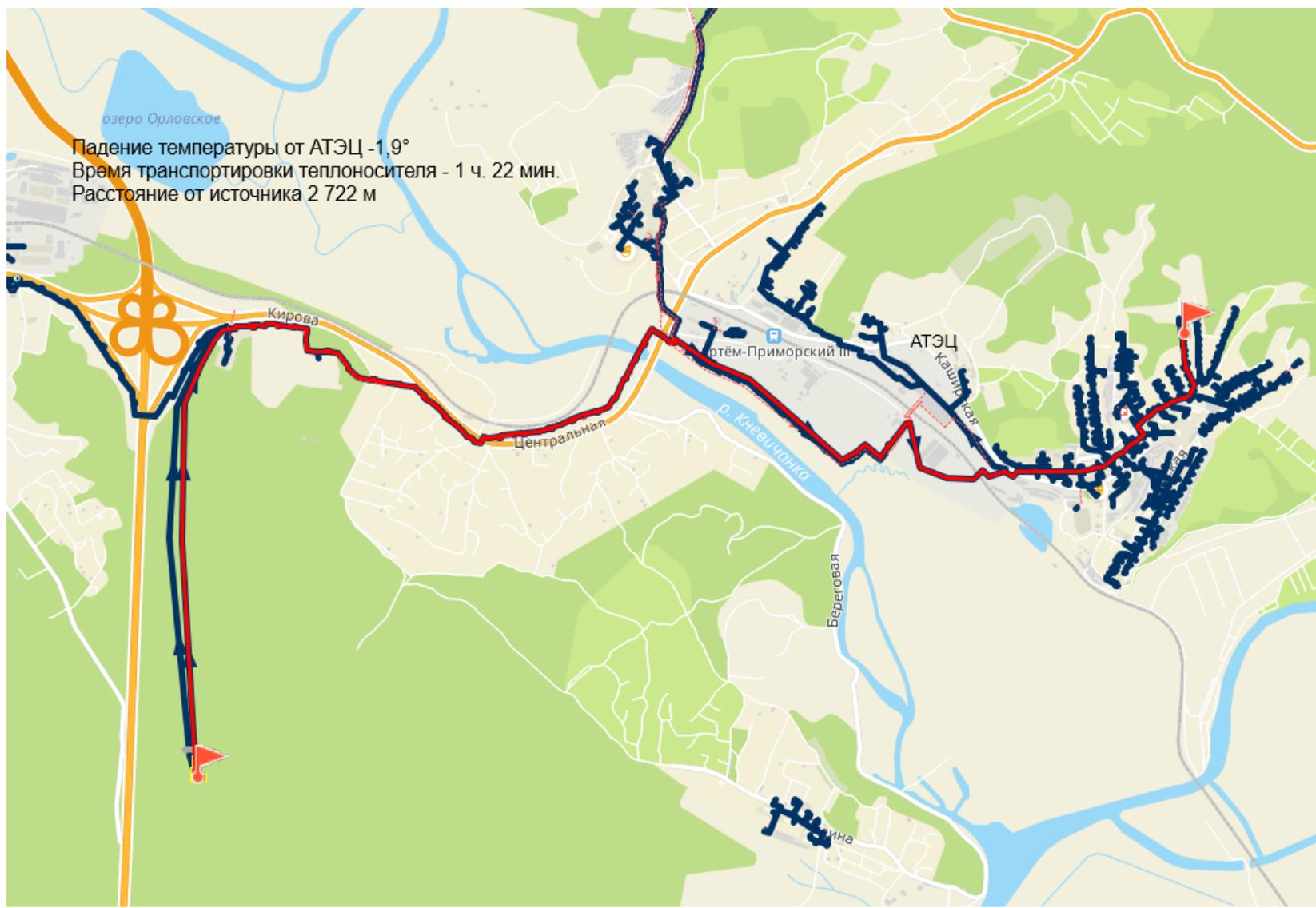
Рисунок 6.6 – Путь для построения пьезометрического графика участка от новой АТЭЦ-2 в направлении п. Артемовский
