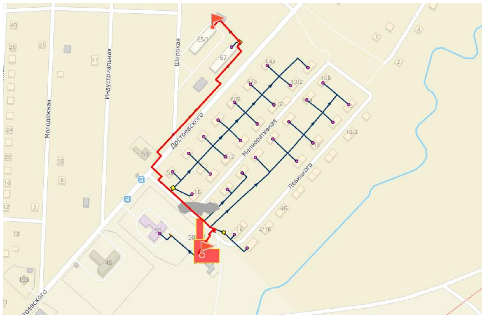
Рисунок 6.21 – Трасса от котельной «Молодежная» до ул. Достоевского, 65/1
